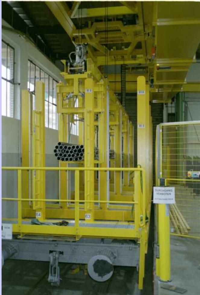
12 m lange Rohre werden automatisch pro Kundenauftrag kommissioniert und zur Schneidmaschine gebracht.
